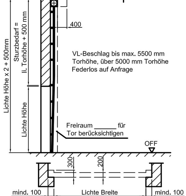
Platzbedarf für federloses System nach techn. Klärung
